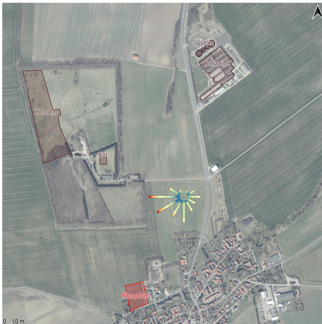
Abb. 1: Übersicht mit den Emissionsquellen, dem Plangebiet, einer Stärkewindrose, auf die weiter unten noch Bezug genommen wird, orthogonale Draufsicht 1536 x 1536 m 2 von {32662880;5655952} bis {32664416;5657488} | Kartengrundlage: DOP, TLBG
