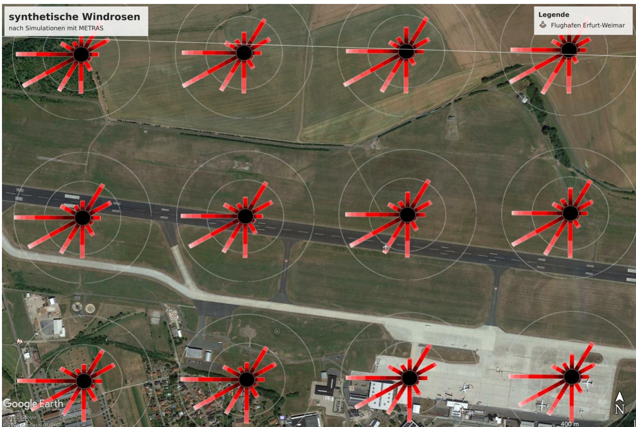
Abb. 8: synthetische Windverteilungen auf der Basis von METRAS-Simulationen (rosa-rot-braun-Balkendiagramme mit schwarzem Zentrum) gemäß [Lit. 19] im Bereich der Emissionsquellen in Großobringen (Zielbereich) sowie im Bereich der Station Erfurt-Weimar des DWD | Auszug aus GoogleEarth
